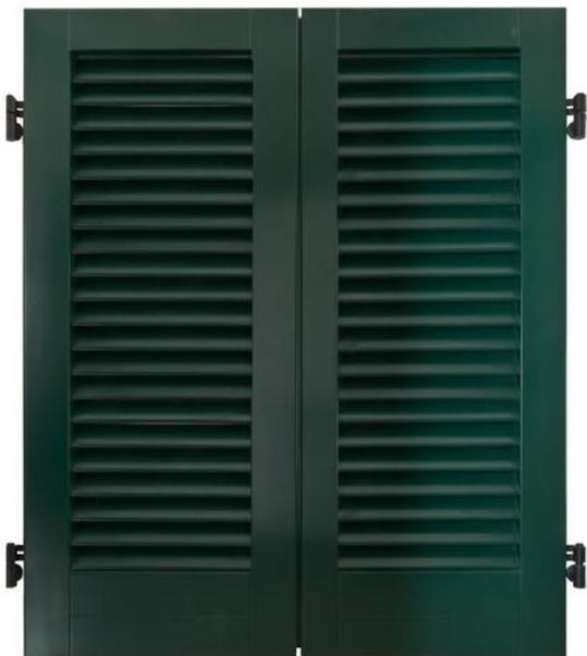
Anta in profilo di legno sez. 102x55 mm con sagoma classica mezza fiorentina. Stecche 70x11 mm legno Abete di Svezia. Verniciatura e laccatura con vernici ad acqua trasparenti semilucide. Ferramenta interna in acciaio verniciato, composto da asta spagnoletta, perni. Fissaggio a parete con arpioni a resina e a murare.
